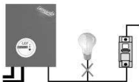
Figura-15 collegamento sbagliato
