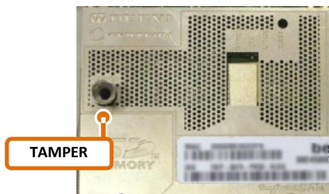
Figura 12 – Posizione switch di TAMPER EzyDriveCAM.
