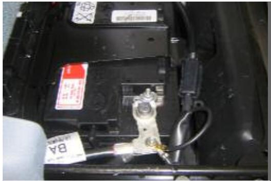
FOTO D: Fusibile batteria auto FORD
