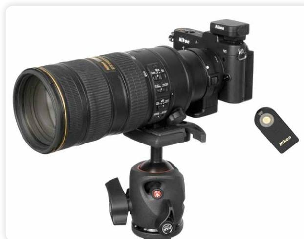
L'impiego sulla Nikon 1 V1 dell'unità GPS [GP-N100](#) consente una perfetta georeferenziazione della località di scatto, con la memorizzazione negli exif non solo della longitudine e latitudine, oltre che dell'ora UTC, ma anche dell'altitudine sul livello del mare. La precisione è elevatissima per tutti e tre i valori.
