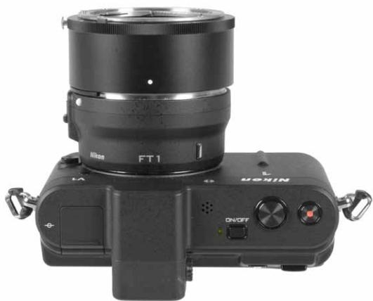
Nonostante sia espressamente dichiarato nelle istruzioni del FT-1 la non compatibilità con qualsivoglia tubo di prolunga, il PK-13 è risultato innestabile, anche se naturalmente solo da un punto di vista meccanico.
