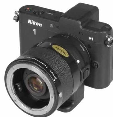
Sia per ragioni di moltiplicazione focale che di compatibilità ottiche abbiamo innanzitutto montato sul FT-1 un vecchio moltiplicatore di focale Nikon Teleconverter TC-200
