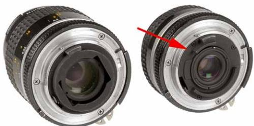
A sinistra un Micro Nikkor AI 55mm f/2.8 pienamente compatibile con l'adattatore FT-1; a destra un Nikkor 20mm f/3.5 AI non compatibile a causa del rilievo brunito indicato dalla freccia rossa che rende meccanicamente impossibile il montaggio dell'obiettivo in questione sull'adattatore.
