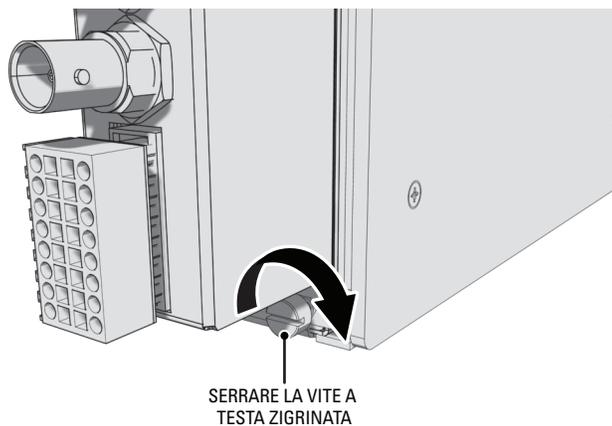
**Figura 6.** Serrare la vite a testa zigrinata per fissare l'unità
