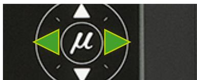
È possibile visualizzare la temperatura di ogni elemento (serbatoio, distributore e ciascun tubo e pistola) selezionando l'elemento stesso con i cursori.
