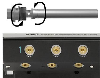
**Avvertenza:** In sede di manipolazione del filtro di uno qualsiasi degli elementi a pressione, provvedere prima alla depressurizzazione del sistema (vedere sezione corrispondente).
