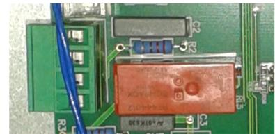
**Avvertenza:** Collegare a 24V (AC o DC). In caso di collegamento a 230V il valore di consumo non sarà inferiore a 50mA.
