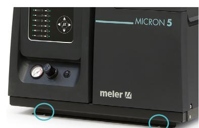
La piastra base consente di estrarre e posizionare il gruppo fusore in tutta semplicità, senza necessariamente utilizzare viti di fissaggio, compatibile con i precedenti modelli 'micron' 4, 8, 16 e gruppo fusore ST. Per il montaggio della piastra base, collocare e posizionare la stessa sul bancale della macchina. Contrassegnare e realizzare quattro fori per viti M8 di fissaggio della piastra base. I fori possono essere del tipo filettati o passanti in funzione del bancale di fissaggio.
