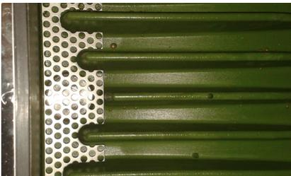
In alcuni casi, il serbatoio di hot-melt deve essere pulito onde preservare le prestazioni dello stesso in termini di capacità di fusione e antiaderenza. Il serbatoio presenta un rivestimento interno in PTFE ed è sufficientemente inclinato per semplificare lo spurgo di hot-melt ed evitare la permanenza di eventuali residui al suo interno, con conseguente carbonizzazione degli stessi.
