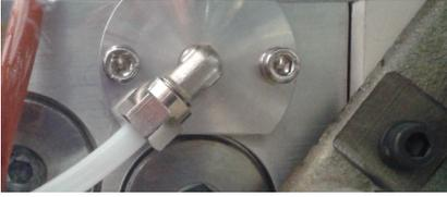
La valvola di depressurizzazione libera il circuito idraulico di pressione rinviando l'adesivo al serbatoio.
