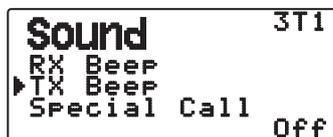
Quando un radiofaro contenente informazioni sulla posizione della stazione (Informazioni sulla mia posizione) viene trasmesso in modalità differente da quella manuale, si può scegliere di attivare l'emissione di un suono tipo bip, oppure no.
