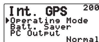
**GPS Only:** Il display mostra solo informazioni GPS; le funzioni di ricezione e trasmissione del ricetrasmittitore sono disattivate, è disponibile soltanto il funzionamento con GPS.
