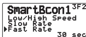
Intervallo di tempo di trasmissione ad alta velocità (10 ~ 180 secondi).
