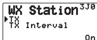
Questa impostazione determina la possibilità o meno di trasmettere i dati meteorologici ottenuti dalla Stazione meteorologica, con la comunicazione di dati APRS.
