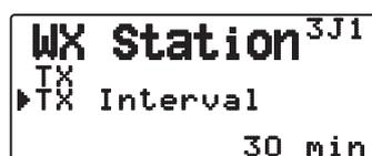
Impostare l'intervallo per la trasmissione dei dati meteorologici assieme alla comunicazione dati APRS.
