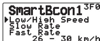
Impostazione bassa velocità (2 ~ 30 <mi/h, km/h o knots>). Quando la velocità è inferiore a questa, i radiofari vengono trasmessi secondo gli intervalli di tempo specificati in "Slow Rate".
