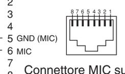
Connettore MIC sul ricetrasmittitore HF
