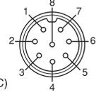
Connettore MIC sul ricetrasmittitore HF
