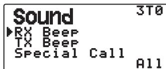
Questo ricetrasmittitore emette un segnale acustico alla ricezione di qualsiasi tipo di pacchetto APRS; per ulteriori descrizioni fare riferimento a "RICEZIONE DATI APRS".
