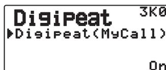
Quando si utilizza il TH-D72 come un ripetitore digitale, configurare se effettuare o meno la ripetizione digitale di un pacchetto che include il proprio segno di chiamata nel percorso pacchetto.
