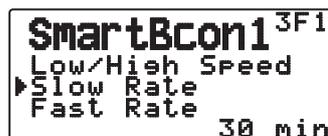
Intervallo di tempo di trasmissione a bassa velocità (1 ~ 100 minuti).
