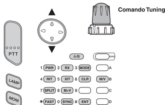
Ogni volta che si preme il tasto desiderato, il commander entra automaticamente nel modo di trasmissione e invia il comando di controllo corrispondente al transporter.
