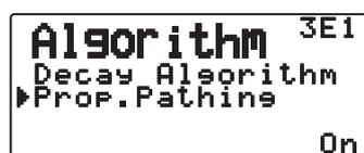
Questa funzione modifica automaticamente il percorso del pacchetto di trasmissione con il trascorrere del tempo.
