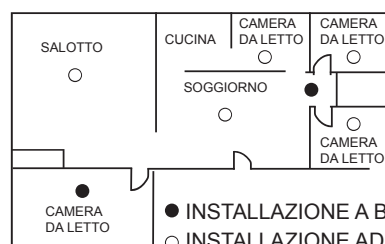
Figura 2: Dove posizionare rivelatori di fumo nel caso di residenze con più di un'area da notte.
