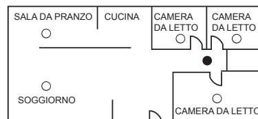
Figura 1: Dove posizionare rivelatori di fumo nel caso di residenze con un'unica area da notte.
