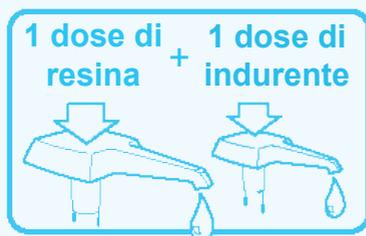
Con minipompe - il giusto rapporto prevede una pompata completa della pompa della resina e una pompata completa della pompa dell'indurente.
