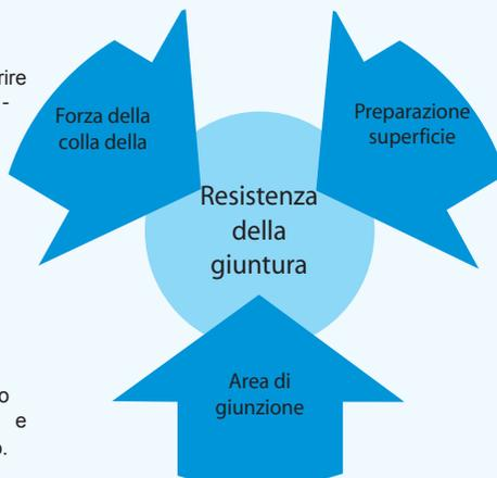
Prima di miscelare la resina epossidica, verificare che tutte le parti che dovranno essere assemblate siano della misura giusta e che la preparazione della superficie sia completa. (Ved. la sezione *Preparazione della superficie 3.1 a pagina 10*). Raccogliere tutti i morsetti e gli utensili necessari per questo tipo di intervento e coprire le aree da proteggere in caso di fuoriuscite.
