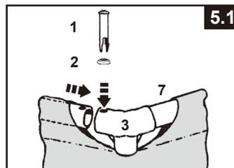
L'ultima operazione di connessione potrebbe essere più complicata da effettuare, per facilitarla è sufficiente alzare contemporaneamente il giunto a T e l'asta di circa 5 cm e inserire l'asta nel giunto mentre facendo pressione verso il basso i due pezzi tornano nella corretta posizione. In questo modo l'asta scivolerà nel giunto a T (vedi disegno 5.2). Assicurarsi che l'ultimo giunto sia montato perfettamente prima di procedere con il montaggio delle gambe.
