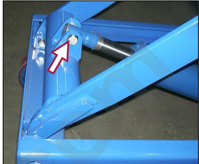
Figura 17 – Perno cilindro.
