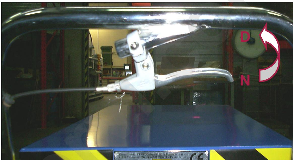
Figura 10 – Dettaglio leva di discesa del carrello.
