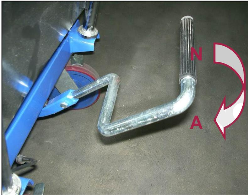
Figura 11 – Dettaglio pedale di sollevamento del carrello.
