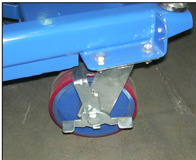
Figura 2 – Freno di stazionamento.
