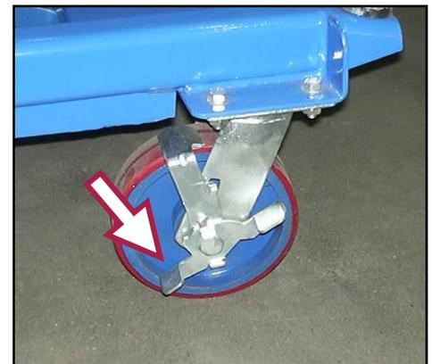
Figura 15 – Sbloccaggio del freno.
