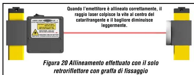
*Figura 20 Allineamento effettuato con il solo retroriflettore con grappa di fissaggio*
