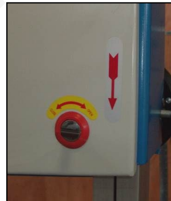
Figura 23 – Senso di rotazione della lama.
