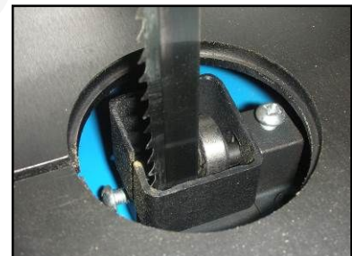
Figura 25 – Dettaglio guida lama inferiore.
