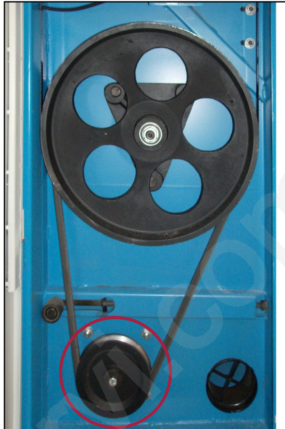
Figura 40 – Bulloni di fissaggio del motore elettrico.
