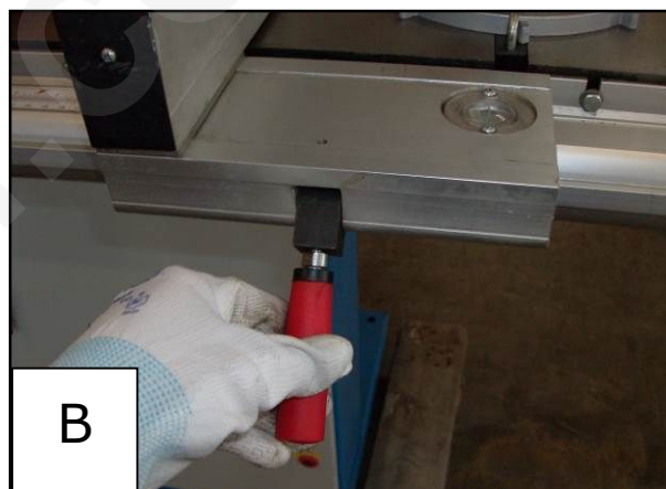
Figura 14 – Leva di fissaggio della squadra (A: Sbloccata – B: Bloccata).
