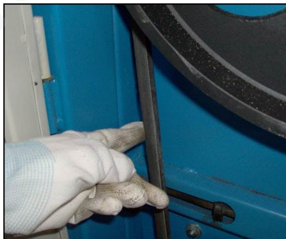
Figura 37 – Cinghia di trasmissione della sega.
