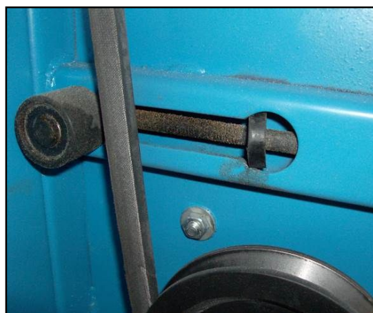
Figura 39 – Regolazione della tensione della cinghia.
