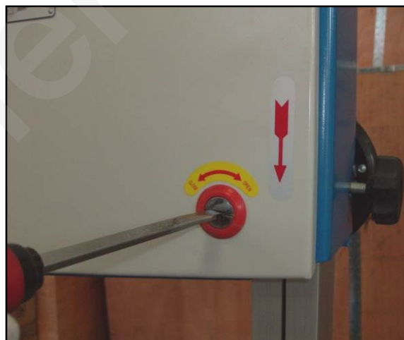
Figura 34 – Apertura serratura portello.
