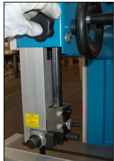
Figura 15 – Carter di protezione lama.
