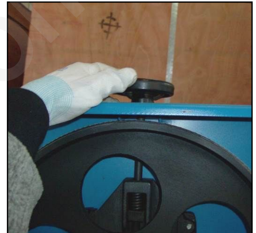
Figura 10 – Regolazione della tensione della lama.
