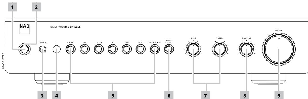
**1 TASTO STANDBY:** con l'interruttore di alimentazione del pannello posteriore impostato sulla posizione di accensione, premere questo tasto per accendere C 165BEE dalla modalità Standby. La spia LED di Standby passa dal colore ambrato a blu. Premere di nuovo il tasto Standby per riportare l'unità in modalità Standby.
