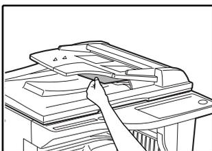
Se non è possibile rimuovere con facilità dall'area di uscita la carta inceppata, aprire la parte mobile del vassoio dell'alimentatore di originali e rimuovere l'originale.
