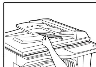
Se un originale di dimensioni piccole A5 (5-1/2" x 8-1/2", ec.) si inceppa, oppure se un originale si inceppa nel vassoio di inversione oppure nell'RSPF (se installato), aprire la copertura lato destro e rimuovere l'originale. Chiudere la copertura lato destro.
