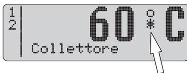
Fig. 6-4 Indicazione di esercizio con protezione antigelo attiva
