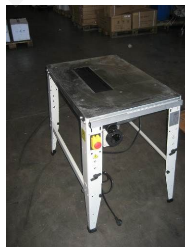
Figura 14 - Banco sega parzialmente montato.
