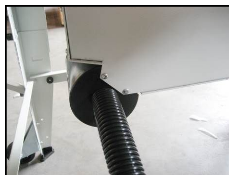
Figura 21 - Collegamento tubazione aspiratore.
