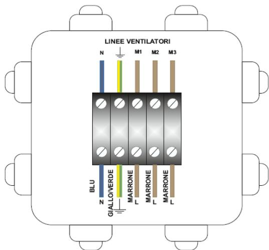
**Figura 9: schema elettrico**
