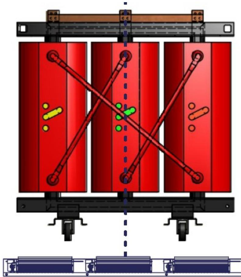
Figura 2: fissaggio ventilatore, vista dal fianco
