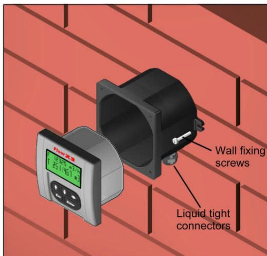
1. Fissare il kit montaggio a muro su una parete, usando le viti fornite.
