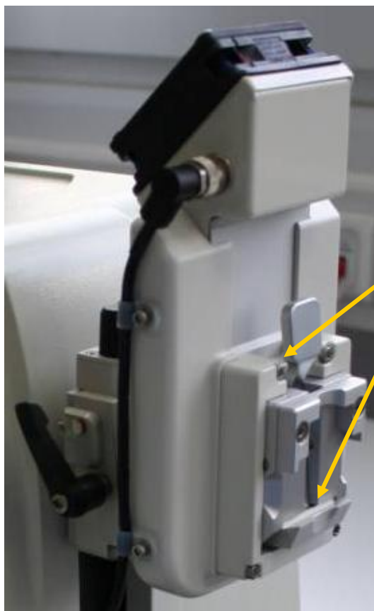
Figura 4: Possibili zone dove le dita possono rimanere incastrate
