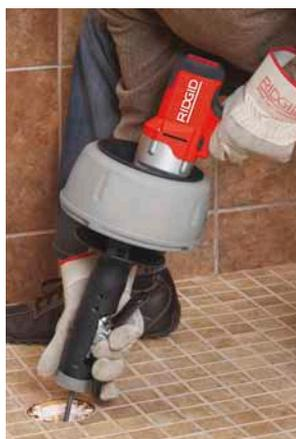
Il cavo da 3/8" (10 mm) nel Modello K-45AF-5 estende la capacità della stasatrice a condutture sino a 2 1/2" (75 mm)
