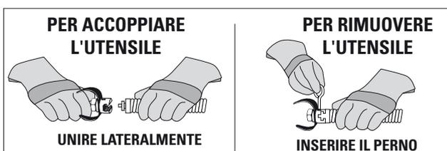
Per i cavi C-4, C-6, C-6IC, C-7, C-8, C-9, C-10, C-11, C-12, C-14, C-15, C-31, C-32, C-33, C-44, C-45 e tutti i Cavi IW C-46
