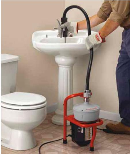
**Dentro il lavandino:** premere la leva e il cavo entra nello scarico. La combinazione dell'esclusivo Tubo guida e dell'AUTOFEED® permette di risolvere facilmente il problema.
