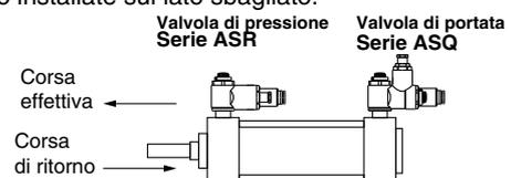
3. Se una valvola a centri chiusi, centri in scarico o centri in pressione viene usata e se l'elettrovalvola viene impostata in posizione centrale, il cilindro potrebbe portarsi nella posizione idonea per ottenere l'equilibrio della pressione e l'equilibrio del carico.
