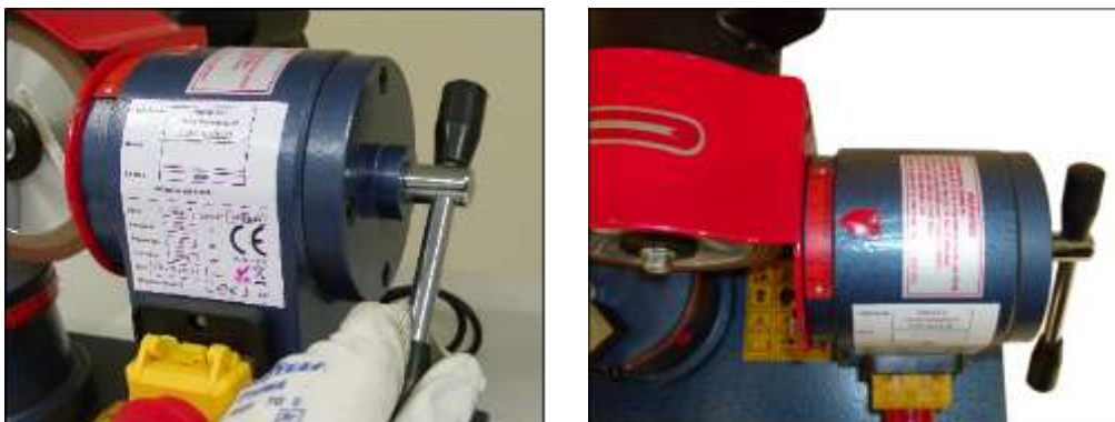
Figura 11 - Inclinazione del gruppo motore/mola.
