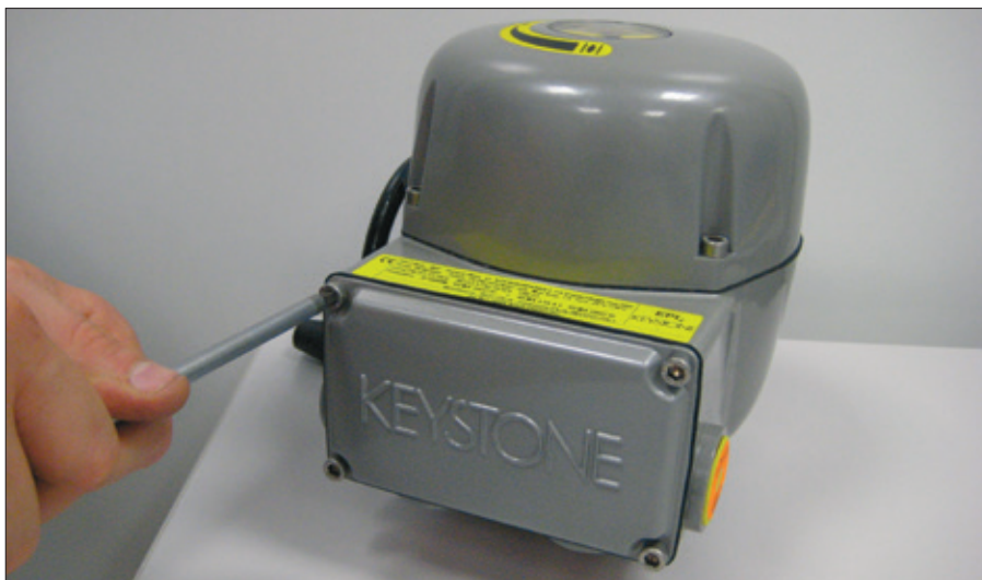
Rimozione del coperchio della morsettiera
