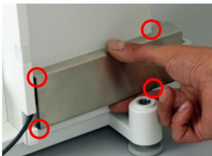
Riporre la piastra di protezione del cavo della **barriera fotoelettrica** sulla parete laterale della bilancia e farla scorrere in avanti nelle apposite cavità dello chassis. **Nota:** la barriera fotoelettrica può essere montata sia sul lato destro che sul lato sinistro della bilancia.
