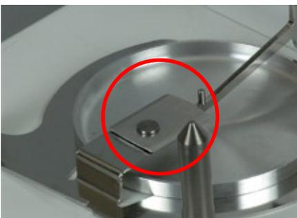
Ruotare la **piastra di fissaggio** di 90° verso sinistra o verso destra in posizione chiusa (la piastra di fissaggio impedisce al supporto di scardinarsi).
