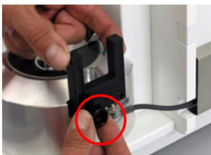
Posizionare la **barriera fotoelettrica** sul paravento e fissarla con le viti a testa zigrinata.
