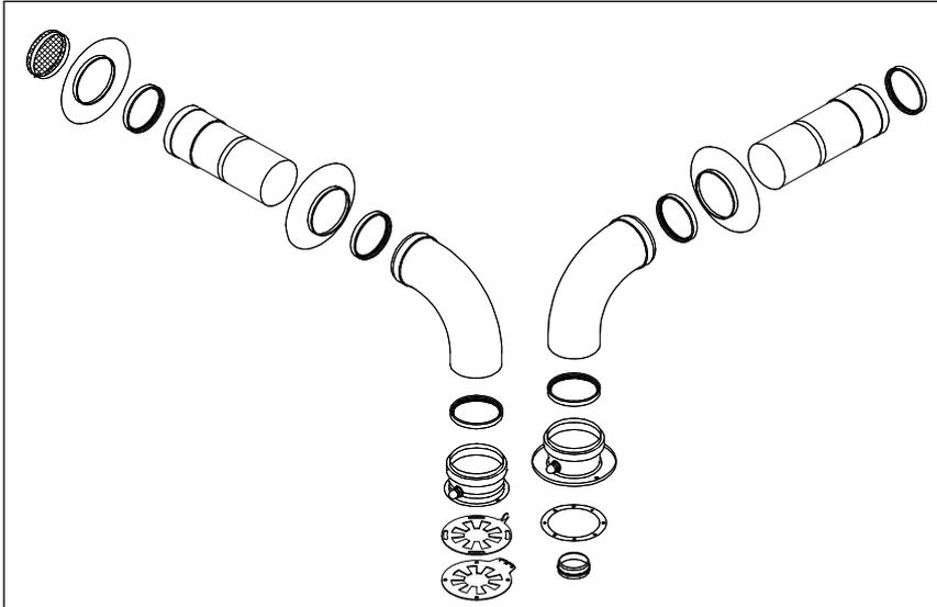
E' adatto solo per **caldaie camera stagna tiraggio forzato**. Permette di scaricare i gas della combustione e di aspirare l'aria per la combustione per mezzo di due condotti sdoppiati Ø80.
