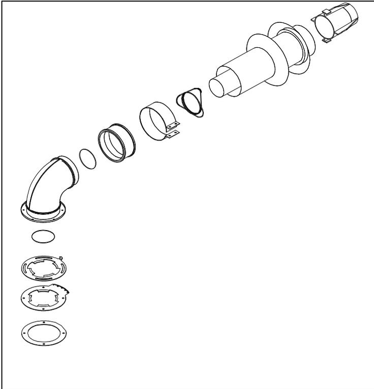
È adatto solo per **caldaie camera stagna tiraggio forzato**. Permette di scaricare i gas della combustione e di aspirare l'aria per la combustione per mezzo di due condotti coassiali, quello esterno Ø100 per l'aspirazione dell'aria, quello interno in alluminio Ø60 per lo scarico dei fumi.
