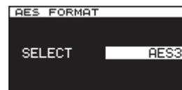
3. Ruotare il selettore **MULTI JOG** per impostare il formato di uscita per **AES 3/11 1/2 OUTPUTS (bilanciate XLR)**.
