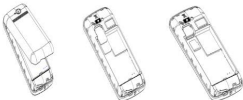
quelli del telefono e premere delicatamente la batteria in posizione.
