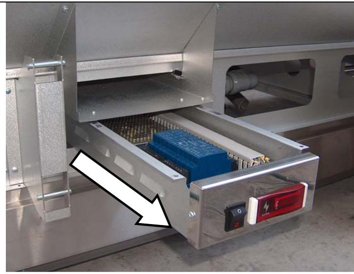
Fig. 2: estrarre il quadro completamente
