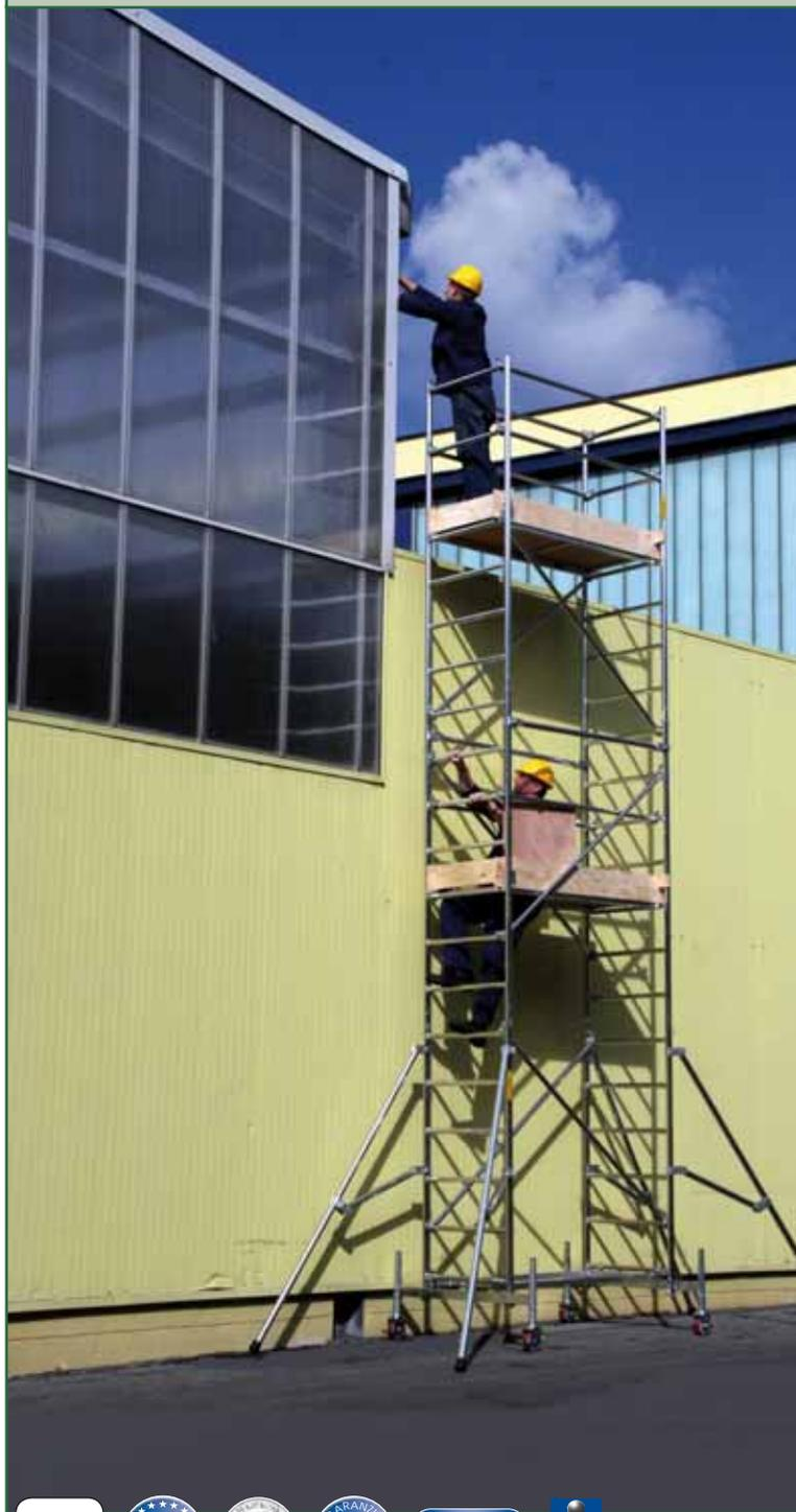
ANDROMEDA è un trabattello in alluminio concepito per utilizzo professionale e per il fai da te. Costituito da moduli da m 2,1 e da m 0,90 per un'altezza massima di lavoro di m 10,18 è ideale per lavori di imbiancatura e manutenzione. È costruito in leggerissima lega di alluminio tubolare Ø 42 mm con gradini zigrinati antiscivolo.
