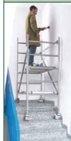
Il Modulo A del trabattello Andromeda alto metri 1,95 con altezza massima di lavoro di m 3,0 passa attraverso porte standard e può essere utilizzato anche zoppo su scale. Ingombro m 1,60 x 0,80.
