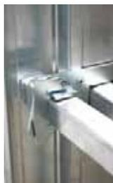
I pioli con superficie di appoggio di mm 30 vengono fissati ai montanti tramite ribordatura. Sono zigrinati e antisdrucchiolo per una solida presa di mani e piedi. Un gancio di sicurezza impedisce lo sfilo accidentale dell'ultimo tronco.
