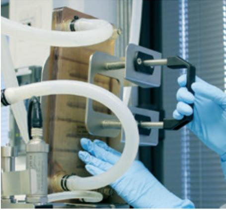
14. Tirare la maniglia del supporto per il raffreddatore dell'aria in uscita monouso.
