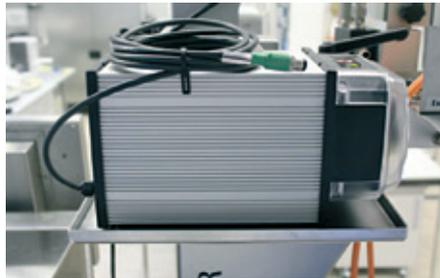
2. Collegare la pompa di scarico della condensa al raccordo Exhcond dell'unità Tower.
