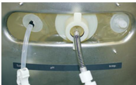
9. Tenere salda la porta dei sensori monouso quando si tira la molla verso la porta del sensore. Spingere l'estremità anteriore del dispositivo di fissaggio nella porta del sensore fino all'arresto e fino a sentire un clic: ora il cavo a fibre ottiche è fissato.
