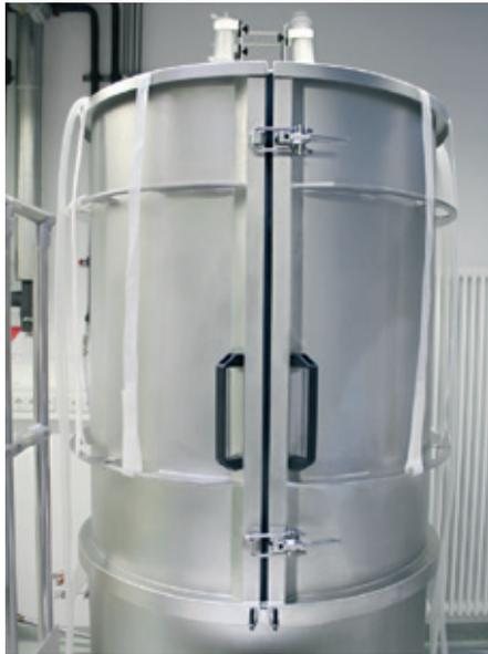
8. Chiudere il secondo sportello e far passare le fasce attraverso l'anello inferiore dell'alloggiamento della sacca. Poi chiudere le fasce con le cinghie in Velcro.
