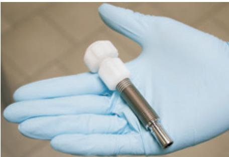
5. Allentare il raccordo filettato (boccola bianca) del dispositivo di fissaggio del cavo a fibre ottiche.
