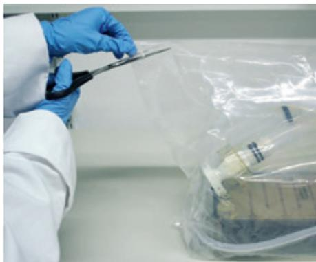
3. Aprire con cura il sacco secondario usando una forbice e togliere il raffreddatore dell'aria in uscita monouso.
