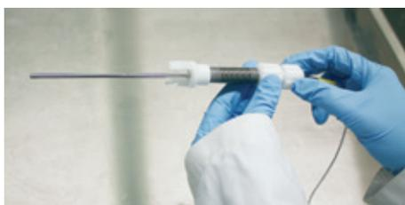
3. Chiudere il raccordo filettato del dispositivo di fissaggio del sensore di temperatura.
