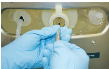
8. Inserire il cavo a fibre ottiche nel foro corrispondente (il cavo a fibre ottiche per pO<sub>2</sub>/DO nel rosso e il cavo a fibre ottiche per pH nel bianco).
