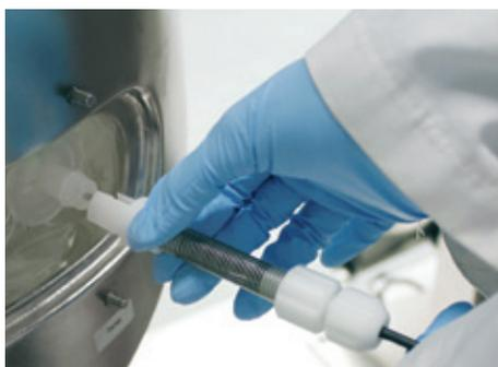
5. Fissare il dispositivo di fissaggio sul portagomma della porta del sensore di temperatura.
