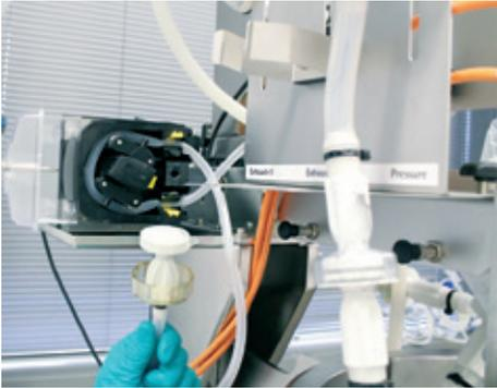
6. Premere sulla testa del raccordo rapido del kit di installazione fino a quando si innesta.
