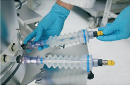
7. Premere con attenzione gli elettrodi nella sacca STR, comprimendo l'adattatore degli elettrodi.
