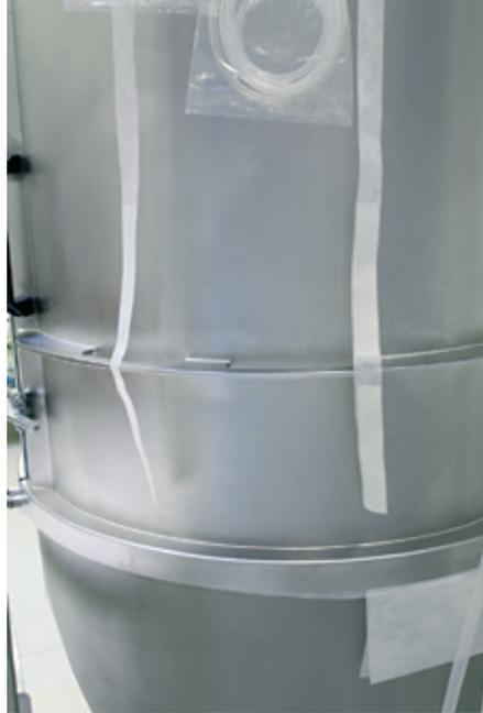
1. Aprire le cinghie in Velcro di tutte le fasce che si trovano sull'anello inferiore dell'alloggiamento della sacca.
