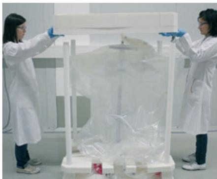
14. Estrarre i tubi dai quattro angoli dell'elemento inferiore in materiale espanso mentre una seconda persona tiene la sacca STR dalla parte della porta di drenaggio.
