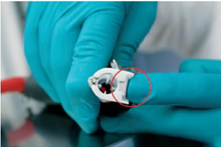
7. Collegare il raffreddatore dell'aria in uscita monouso ('ingresso' dell'acqua di raffreddamento) del kit di installazione all'"ingresso" dell'acqua di raffreddamento del raffreddatore dell'aria in uscita monouso.
