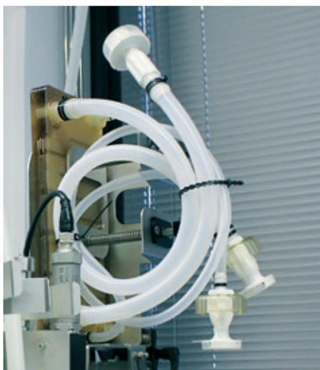
7. Spingere indietro la maniglia lentamente e facendo attenzione in modo che il raffreddatore dell'aria in uscita monouso si fissi automaticamente grazie alla forza elastica.
