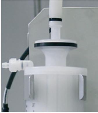
4. Mettere il tubo di insufflazione munito di raccordo Tri-clamp e portagomma sulla guarnizione Tri-clamp.
