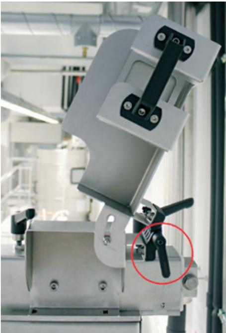
18. Per il BIOSTAT® STR 500|1000 l'angolo del supporto per il raffreddatore dell'aria in uscita monouso viene regolato di nuovo:
