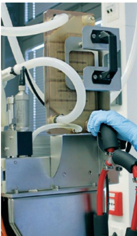
13. Togliere il tubo dall'ingresso dell'acqua di raffreddamento del raffreddatore dell'aria in uscita monouso.
