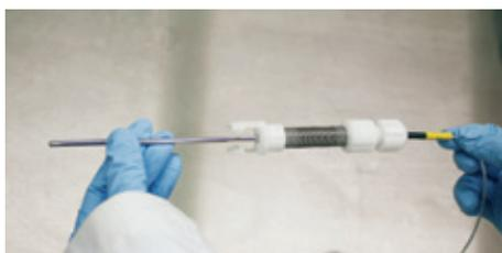
2. Spingere il sensore di temperatura nel dispositivo di fissaggio fino a quando il raccordo filettato si trova sulla guaina isolante nera del sensore.
