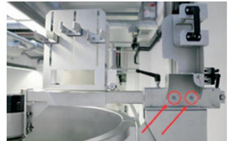
2. Per la sacca STR 500|1000 si deve regolare l'angolo del supporto per il raffreddatore dell'aria in uscita monouso.
