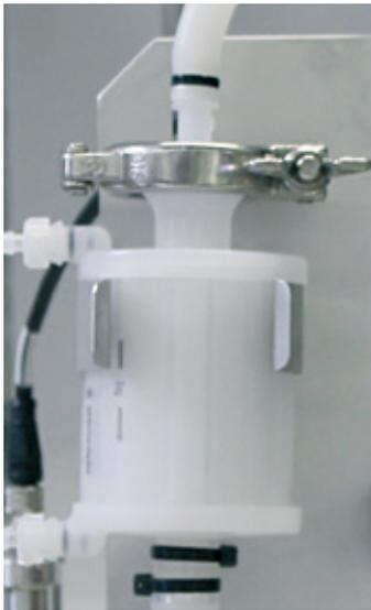
5. Chiudere il morsetto Tri-clamp attorno alla connessione Tri-clamp della linea di filtrazione e del tubo di insufflazione.
