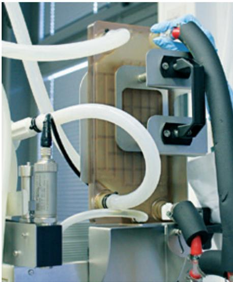
11. Togliere il tubo dall'uscita dell'acqua di raffreddamento del raffreddatore dell'aria in uscita monouso.
