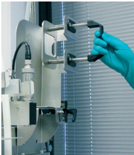
5. Tirare la maniglia del supporto del raffreddatore dell'aria in uscita monouso per sbloccare il fissaggio.
