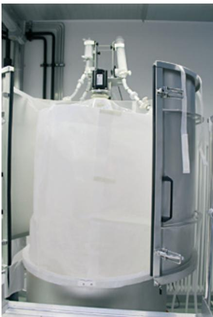
5. Una volta che la porta superiore è collegata al magnete del motore, applicare il "Bag tester fleece T" attorno alla sacca STR.
