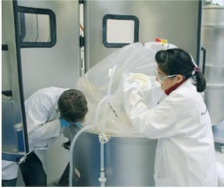
21b. Togliere la sacca STR 500|1000 dall'alloggiamento della sacca tenendola a livello della porta superiore e di drenaggio e facendo passare la linea di drenaggio attraverso il fermo della porta di drenaggio (sono richieste tre persone).
