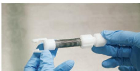
1. Aprire il raccordo filettato del dispositivo di fissaggio del sensore di temperatura.
