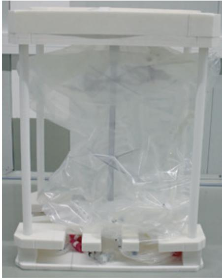
11. Prelevare la linea di drenaggio che si trova sull'elemento superiore in materiale espanso (per la sacca STR 500|1000 si deve prima togliere un piccolo elemento in materiale espanso):
