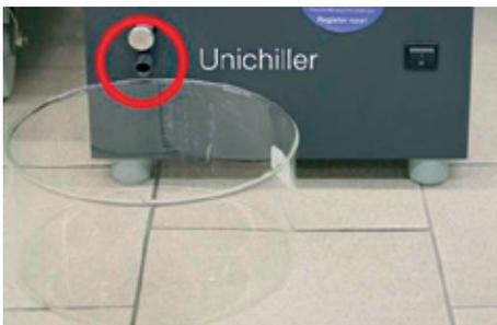
7. Durante lo smontaggio del raffreddatore dell'aria in uscita monouso l'acqua fuoriesce da questo attraverso lo scarico di troppo pieno dell'Unichiller 006.
