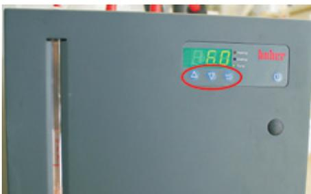
6. Regolare la temperatura dell'Unichiller 006 a 6°C (vedi il "Manuale d'uso di Unichiller 006").
