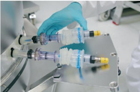
8. Sollevare con attenzione gli elettrodi e mettere l'elemento di appoggio sotto gli elettrodi. Poi fissare l'elemento di appoggio sul vassoio apposito per mezzo della vite di fissaggio.
