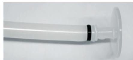
3. Applicare la guarnizione Tri-clamp sul raccordo Tri-clamp della linea di filtrazione.
