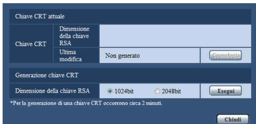
2. Selezionare "1024bit" o "2048bit" per la lunghezza del CRT da generare per "Generazione chiave CRT" - "Dimensione della chiave RSA".
