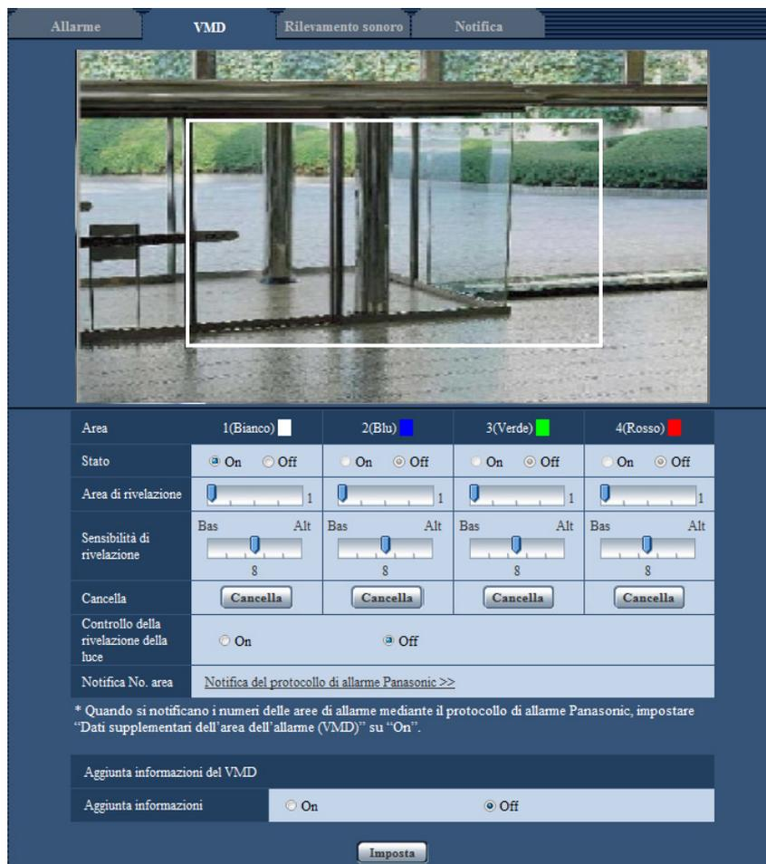
2. Regolare "Area di rivelazione" e "Sensibilità di rivelazione" utilizzando il cursore di scorrimento. Far riferimento a pagina 126 per ulteriori informazioni circa la "Sensibilità di rivelazione" e l'"Area di rivelazione". L'area attualmente visualizzata e la sua sensibilità di rilevamento verranno visualizzate nella sezione "Area di rivelazione". Modificare le aree e le impostazioni di "Area di rivelazione" e "Sensibilità di rivelazione" in base alla necessità.
