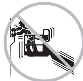
Non sostituire componenti importanti per la stabilità della macchina con componenti con peso o specifiche tecniche differenti.
