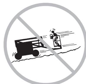
Ridurre la velocità di traslazione in base alle condizioni del suolo, del traffico, alle pendenze, alla presenza di personale, e agli altri fattori che possono essere causa di collisioni.
