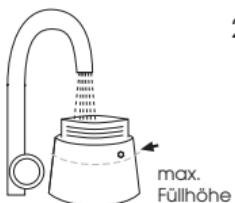
2. Füllen Sie Wasser in das Unterteil des Espresso-kochers bis maximal kurz unter das Sicherheitsventil. Das Sicherheitsventil darf **nicht** unter Wasser liegen.
