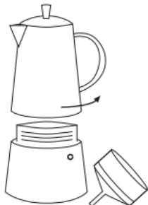
1. Dévissez la cafetière napolitaine en tenant la partie supérieure et inférieure et en tournant dans le sens contraire des aiguilles d'une montre. Retirer le manchon exothermique.
