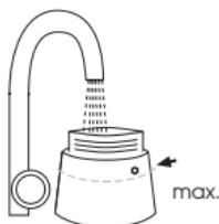
2. Remplissez d'eau la partie inférieure de la cafetière napolitaine jusqu'à la limite de la soupape de sécurité au maximum. La soupape de sécurité ne doit **pas** être dans l'eau.
