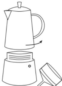
1. Schroef het espresso-apparaat uiteen door het boven- en onderdeel aan het middenstuk vast vast te nemen en draai naar links. Neem de trechter eruit.
