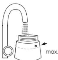
2. Vul water in het onderste deel van het espresso-apparaat tot maximaal net onder het veiligheidsventiel. Het veiligheidsventiel mag **niet** onder water zitten.
