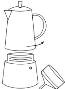
1. Separare le due parti della caffettiera, tenendo saldamente in mano la parte superiore e quella inferiore e ruotando in senso antiorario. Estrarre l'imbutino.
