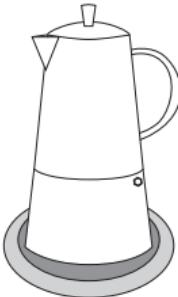
5. Zet het espresso-apparaat op het kookelement en verhit het. We raden u aan de espresso op niet te hoge temperatuur klaar te maken. Zo vermindert u overkoken en ontziet u het apparaat. De espressokoffie stijgt onder lichte dampontwikkeling en zacht borrelen in het bovenste reservoir. Neem het apparaat onmiddellijk van het kook-element, van zodra dit geluid stopt.
