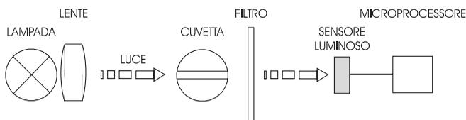
Una lampada al tungsteno, controllata da un microprocessore, emette una radiazione luminosa che viene dapprima allineata e quindi colpisce il contenuto della cuvetta. Il cammino ottico è determinato dal
