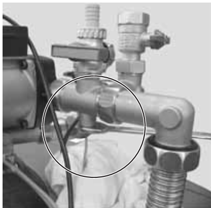
Fig. 5-4 Rimozione del tubo capillare del manometro
