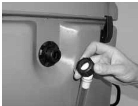
Fig. 8-2 Controllo scarico condensa
