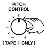
Ruotare la manopola PITCH CONTROL in senso orario aumenta la velocità di riproduzione e innalza l'intonazione del 10%.
