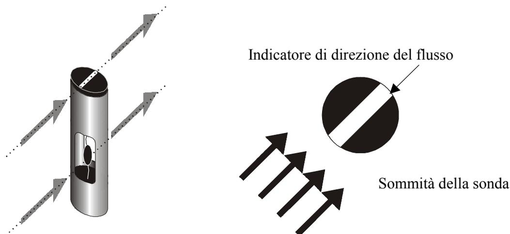
La sonda va mantenuta ortogonale al flusso e non va inclinata rispetto ad esso:
