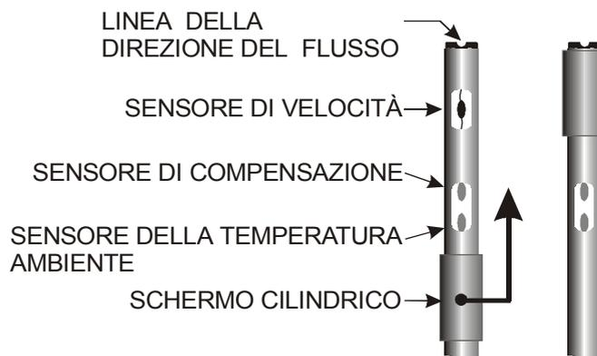
Si posiziona la testa della sonda nel flusso d'aria da misurare e si preme il tasto di reset <0>. Nella barra dei comandi apparirà la scritta null\_A, null\_B o null\_C a seconda dell'ingresso in cui è collegato il modulo. Premere il tasto funzione corrispondente per azzerare la misura: eventuali errori (derive) sui valori istantanei della velocità e della portata vengono annullati.
