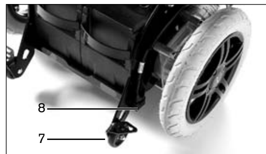
Fig. 3 Ruotina antiribaltamento / spina con cavo della batteria
