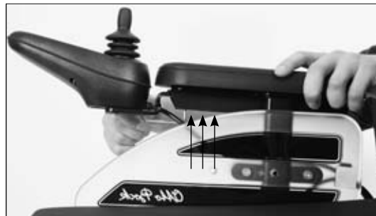
III. 15 Adaptation du boîtier de commande
