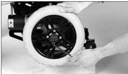
Fig. 31 Smontaggio della ruota posteriore
