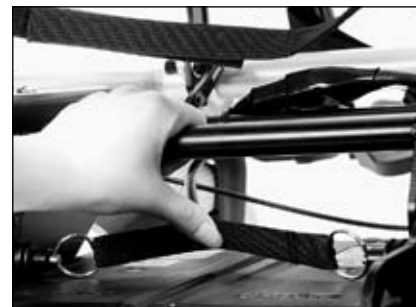
III. 6 Desserrage du dispositif de verrouillage du siège
