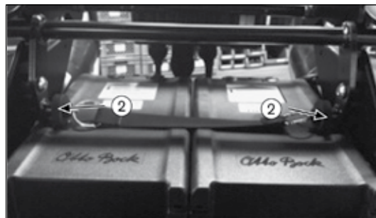
Abb. 11a Asta di blocco e perni di bloccaggio inseriti
