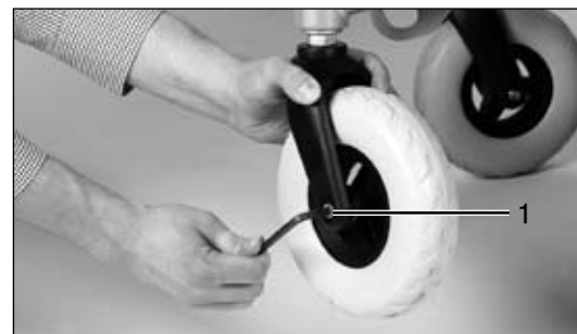
III. 32 Démontage de la roue avant
