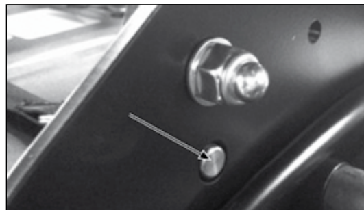
III. 11b Boulons de verrouillage enclenchés
