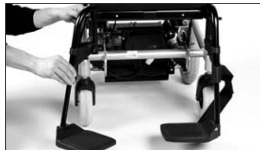
III. 16 Dispositif de blocage du repose-pied
