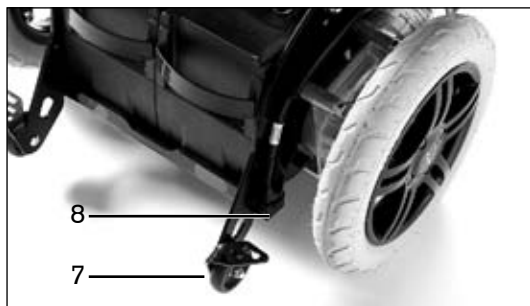
III. 3 Anti-bascule/Connecteur avec câble de batterie
