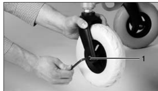
Fig. 32 Smontaggio della ruota anteriore
