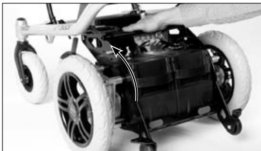
Fig. 10 Fissaggio degli accumulatori
