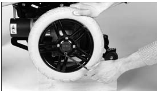
III. 31 Démontage de la roue motrice
