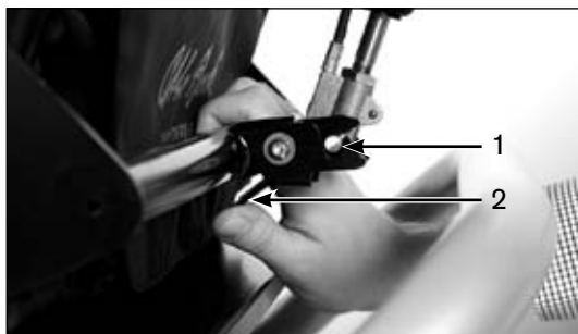
III. 26 Boulon transversal fixé sur le support
