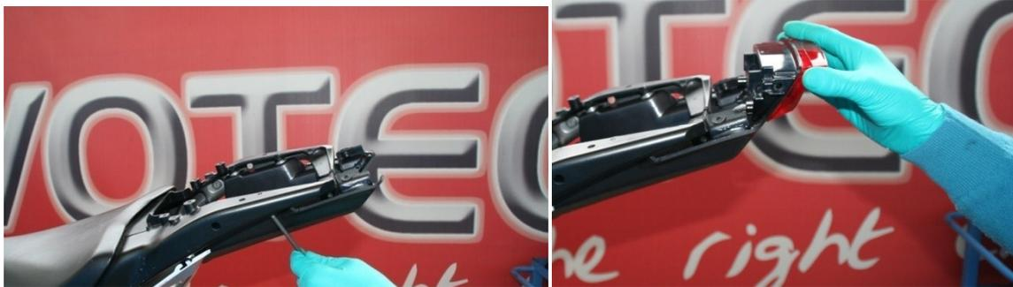
10) Rimontare il dispositivo apertura sella e procedere al montaggio del codino verniciato.
