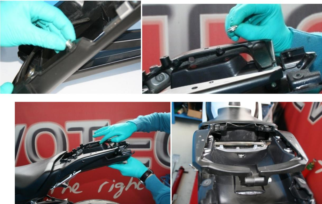
9) Utilizzando le 4 viti di serie, vincolare il particolare termoformato Evotech al telaio posteriore. Innestare il fanale di serie nell'apposito vano, facendo passare i cavi elettrici all'interno della struttura termoformatata.
