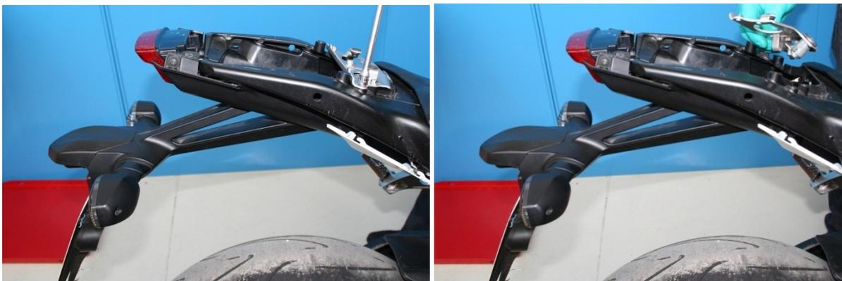
4) Allentare le due viti autofilettanti come indicato in figura. Allentare di seguito le 4 viti testa a brugola di fissaggio del portatarga di serie.
