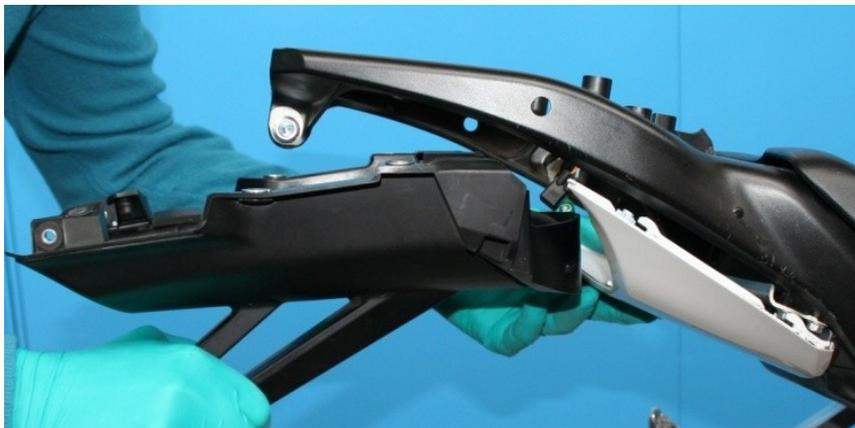
6) Recuperare le due bocche elastiche come indicato in figura e reinnestarle nella particolare termoformato presente nel kit.
