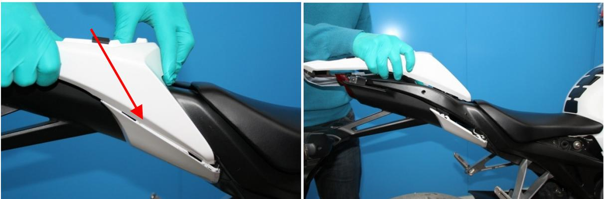
**3)** Allentare le viti di fissaggio del dispositivo apertura sella e rimuoverlo.
