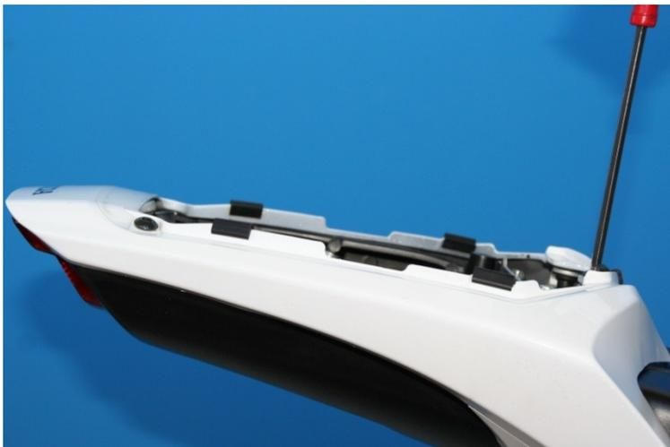
**12)** Utilizzando la minuteria indicata nella vista esplosa in coda, montare il supporto targa alla staffa in alluminio ossidata nera. Montare il sottoassieme sulla moto, facendo passare i vari cavi di alimentazione di dispositivi di illuminazione (luce targa o frecce) eventualmente presenti.
