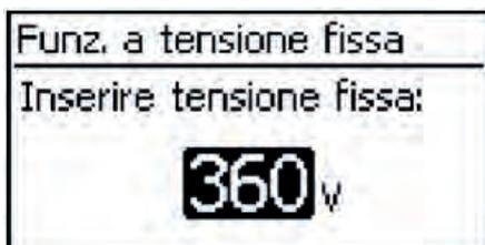
L'apparecchio può regolare la tensione di ingresso su un valore impostabile manualmente. In tal modo si disattiva l'impostazione automatica dell'inseguimento MPP. La tensione di ingresso può essere impostata in un range i cui estremi corrispondono alla tensione di ingresso massima e minima. Esempio di applicazione: celle a combustibile
