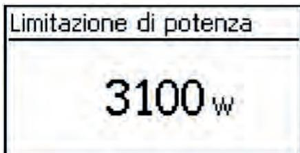
La potenza di uscita dell'inverter può essere limitata manualmente fino a minimo 500 W. Se la potenza è stata limitata manualmente, sulla visualizzazione di stato compare il simbolo Riduzione potenza e il valore di misura **Riduzione potenza / Causa: Progr. utente.**
