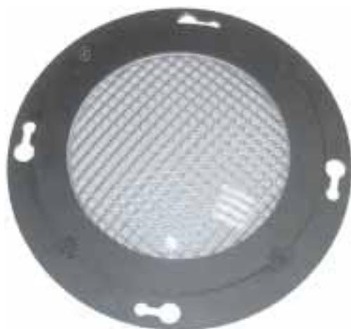
**lente prismatica:** massima diffusione e uniformità della miscelazione del colore. Adatta a proiezioni ravvicinate, a 4/5 metri dal soggetto da illuminare. Angolo di proiezione: da 51 a 80° (1/10 peak angle)
