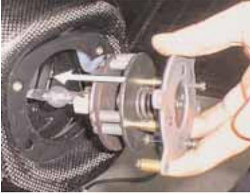
**Attenzione:** raccomandiamo di effettuare l'allineamento della lampada del sistema ottico per non surriscaldare i filtri diecrici all'interno dell'apparecchio; riferitevi al paragrafo 13 per le istruzioni operative.
