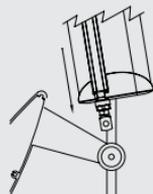
Unire lo stelo all'attacco utilizzando l'apposita vite/dado in dotazione. Serrare completamente le viti alle piastri.
