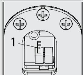
Selezionare la corsa desiderata (Raywin 600N ha 3 corse, 450N ha 2+3 corse, 200N ha 3 corse), seguendo il settaggio dei dip-switch secondo lo schema a seguire. Attenzione ogni dip-switch ha 3 (tre) possibili posizioni.
