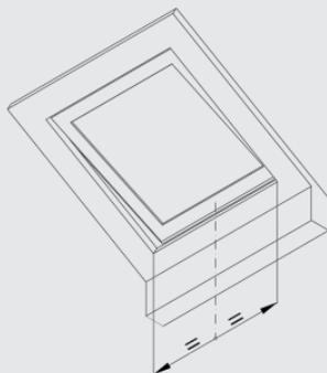
**Pale frangisole:** Segnare con la matita la posizione dei 3 fori di fissaggio della staffa di supporto
