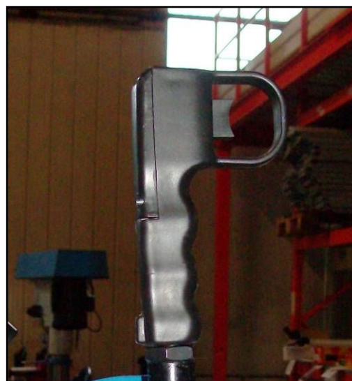
Figura 10 – Interruttore di avviamento di sicurezza.
