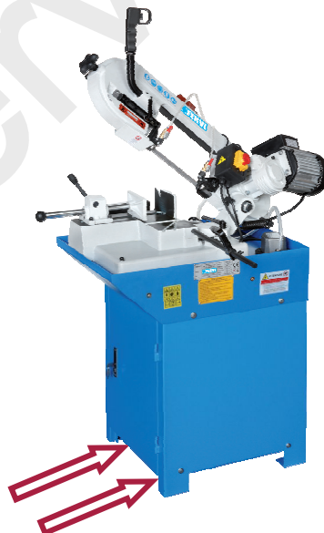
Figura 15 Sollevamento con carrello elevatore.
