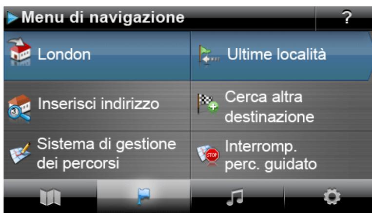
Nella Vista menu, tutte le funzioni del software sono disposte in una struttura gerarchica e possono essere richiamate tramite i pulsanti sullo schermo touchscreen del navigatore. Ogni pulsante apre un livello successivo, il quale consente a sua volta di accedere ad altre opzioni importanti per questo menu o questa funzione. Se a un pulsante non è abbinato alcun livello successivo di menu, la funzione viene eseguita direttamente.
