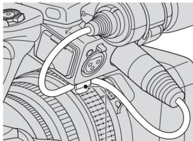
Inserire il cavo nel fermacavo esterno.
