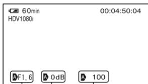
Valore del diaframma      Valore del guadagno      Valore della velocità dell'otturatore
