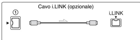
Dispositivo compatibile con HDV1080i
