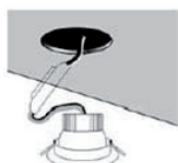
3 Connessione led driver a linea elettrica
