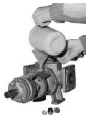
Riempimento della pompa
