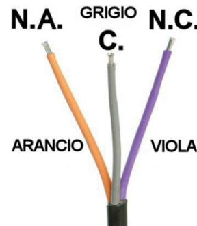
Figura 5 – Configurazione dei contatti, cavo di segnalazione
