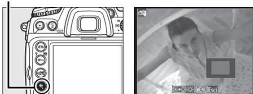
Quando si ingrandisce la vista dell'obiettivo, viene visualizzata una finestra di navigazione nell'angolo in basso a destra del display. Utilizzate il multiselettore per scorrere nelle cornici dell'area AF.
