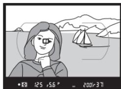
È possibile ruotare il blocco del selettore di messa a fuoco nella posizione di blocco (L) dopo la selezione, per evitare che il punto AF selezionato venga cambiato quando si preme il multiselettore.
